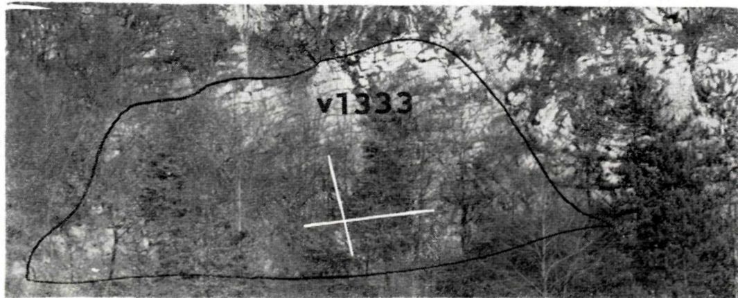
Obr. 6. Urpín — Banská Bystrica — masív slienitých vápencov s rovnorodým celkom v1333 a vyznačením línií merania
